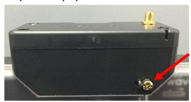
Рисунок 6.1 – винт крепления корпуса модуля связи
