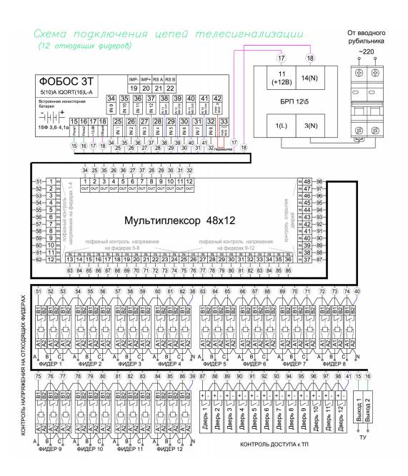
Рисунок Б.8 - Маркировка зажимов и пример схемы подключения дополнительных цепей счетчика электрической энергии статического трехфазного ФОБОС 3 с функцией телемеханики с применением мультиплексора «Вавиот»
