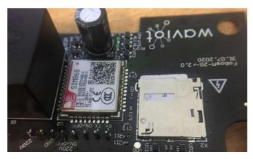
Рисунок 6.8 – Плата сменного модуля связи 2G.
