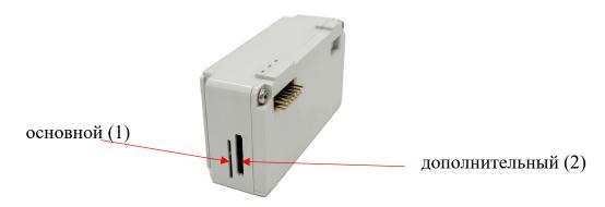
Рисунок 6.10 – Место установки SIM-карт в сменный модуль связи
