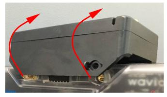
Рисунок 6.2 – Снятие модуля связи.
