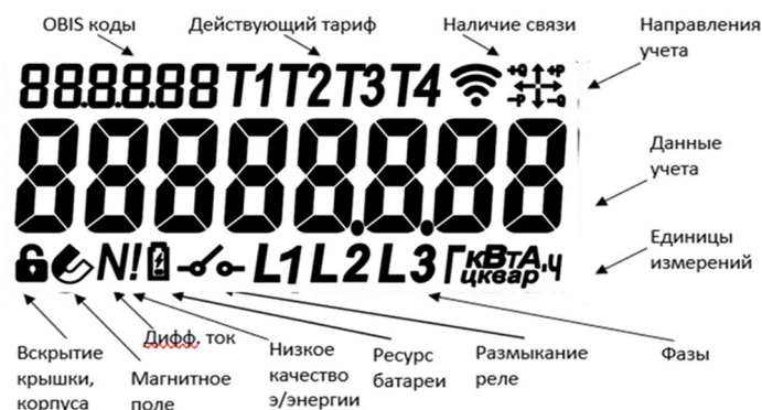
Рисунок 3.3 - Карта сегментов на жидкокристаллическом дисплее и их назначение
