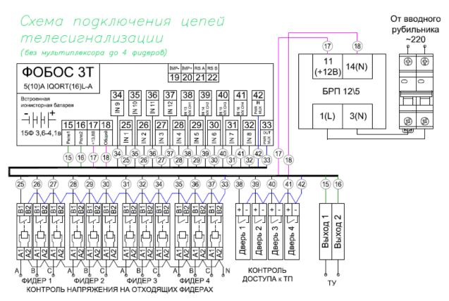
Рисунок Б.7 - Маркировка зажимов и пример схемы подключения дополнительных цепей счетчика электрической энергии статического трехфазного ФОБОС 3 с функцией телемеханики
