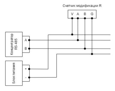
Рисунок 6.11 — схема подключения интерфейса RS-485 счетчиков модификации R
