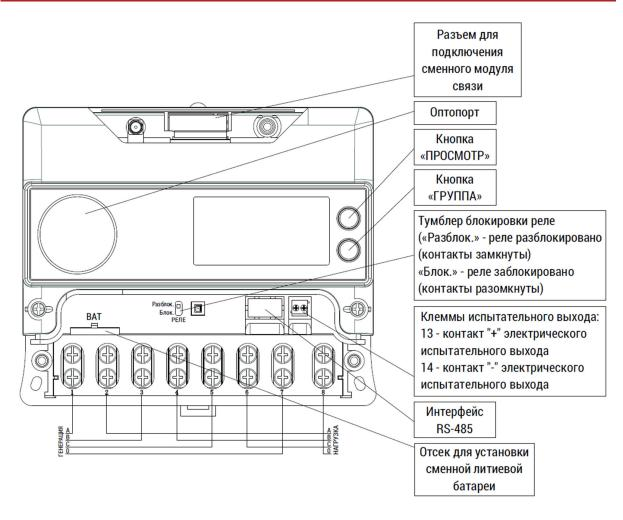
Рисунок Б.11 — Маркировка зажимов и пример схемы подключения счетчика электрической энергии статического трехфазного ФОБОС 3, шкафного исполнение, модели корпуса M(1)
