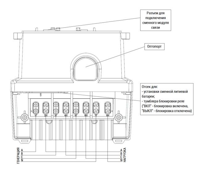
Рисунок Б.9 – Маркировка зажимов и пример схемы подключения счетчика электрической энергии статического трехфазного ФОБОС 3, исполнение «Сплит», модели корпуса SM(1)
