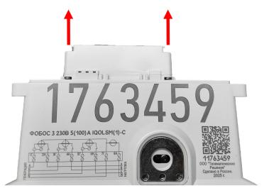
Рисунок 6.4 – Снятие модуля связи.
