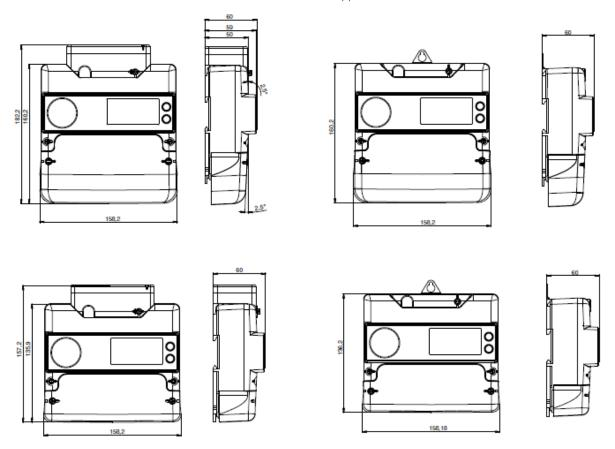
Рисунок А.2 - Габаритные и установочные размеры счетчиков шкафного исполнения модели корпуса M(1)
