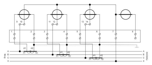
Рисунок Б.5 - Схема четырехпроводного трансформаторного (3 трансформатора тока) подключения счетчика. (Альтернативная)
