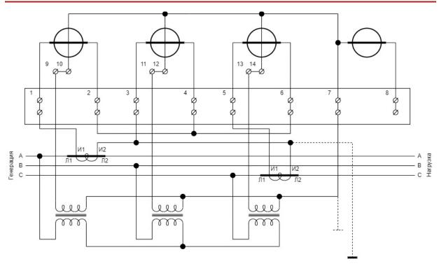
Рисунок Б.3 - Схема трехпроводного трансформаторного (2 трансформатора тока, 3 трансформатора напряжения) подключения счетчика.
