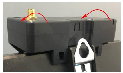
Рисунок 6.5 – Установка сменного модуля связи.
