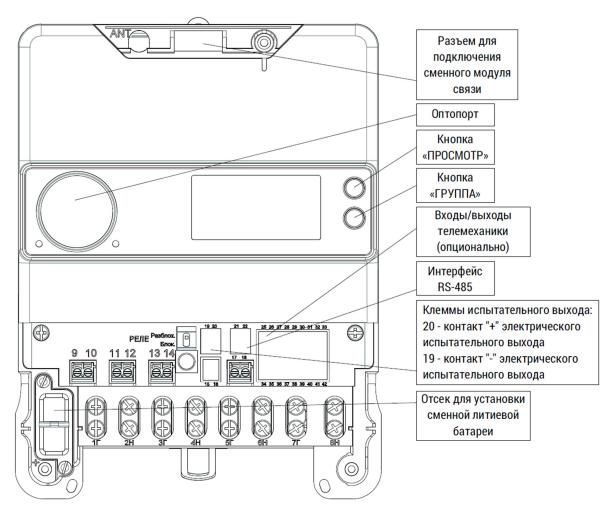
Рисунок Б.10 – Маркировка зажимов счетчика электрической энергии статического трехфазного ФОБОС 3 трансформаторного включения
