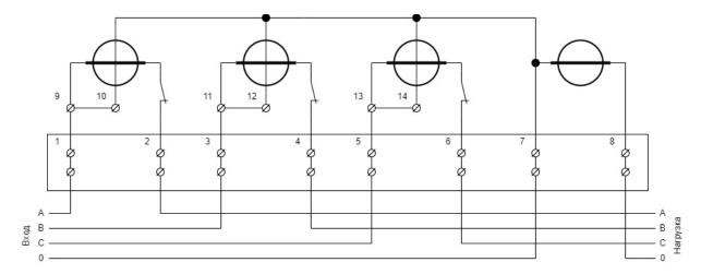
Рисунок Б.1 - Схема четырехпроводного непосредственного подключения счетчика.
