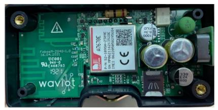
Рисунок 6.9 – Плата сменного модуля связи 2G/4G
