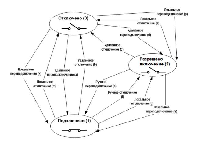
Рисунок 5.1 – Схема переходов состояний реле нагрузки.
