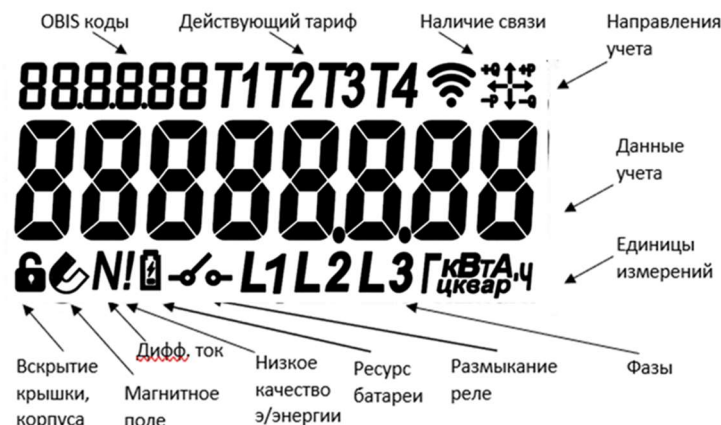
Рисунок 3.3 – Карта сегментов дисплея и их назначение
