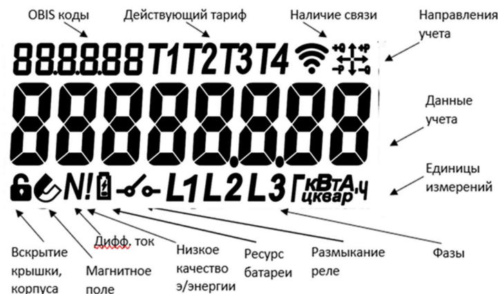
Рисунок 3.3 – Карта сегментов дисплея и их назначение
