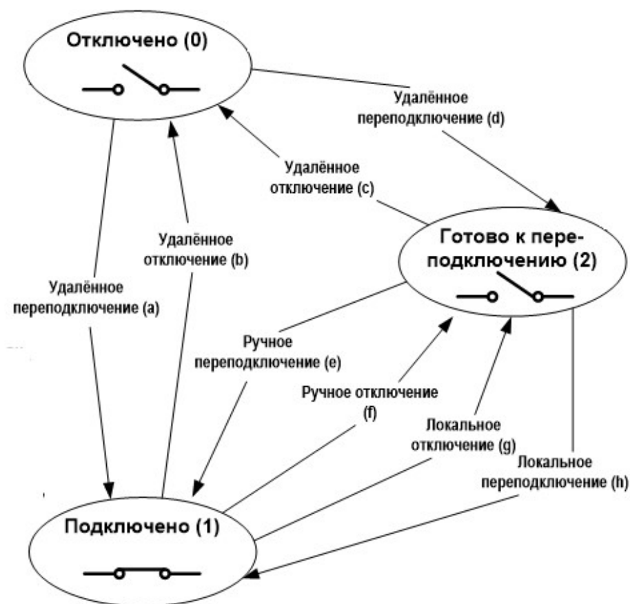
Рисунок 5.1 – Схема переходов состояний реле нагрузки.
