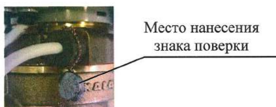
Рисунок 2 – Место нанесения знака поверки
