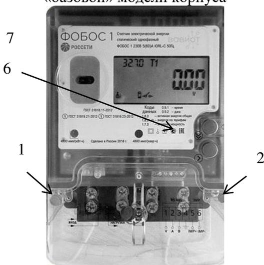
Счетчик исполнения «Сплит» «базовой» модели корпуса с кожухом
