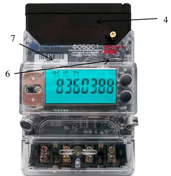
Счетчик исполнения «Сплит» модели корпуса S(1)
