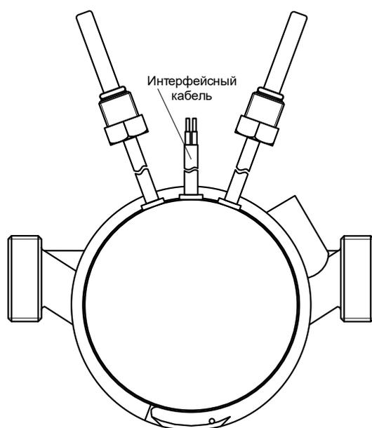
Рисунок 4. Расположение кабелей, проводных интерфейсов счетчиков тепла «Гефест», исполнений Гефест хх.I, Гефест хх.M, Гефест хх.R, Гефест хх.IF и Гефест хх.IL.
