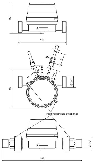
Рисунок 2. Счетчик тепла
