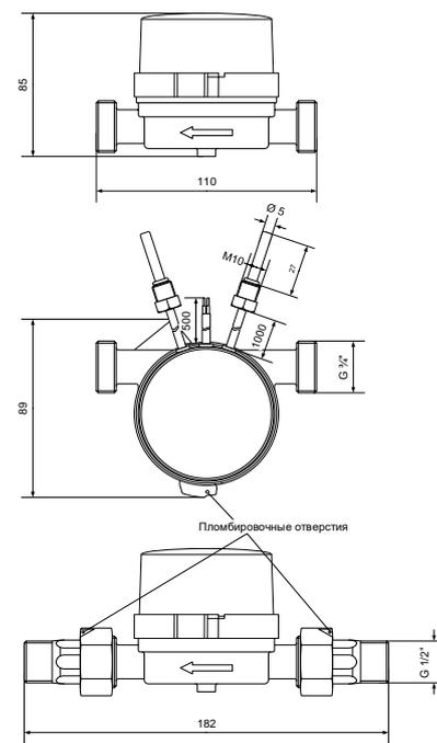
Рисунок 3. Счетчик тепла
