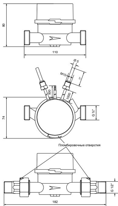
Рисунок 1. Счетчик тепла
