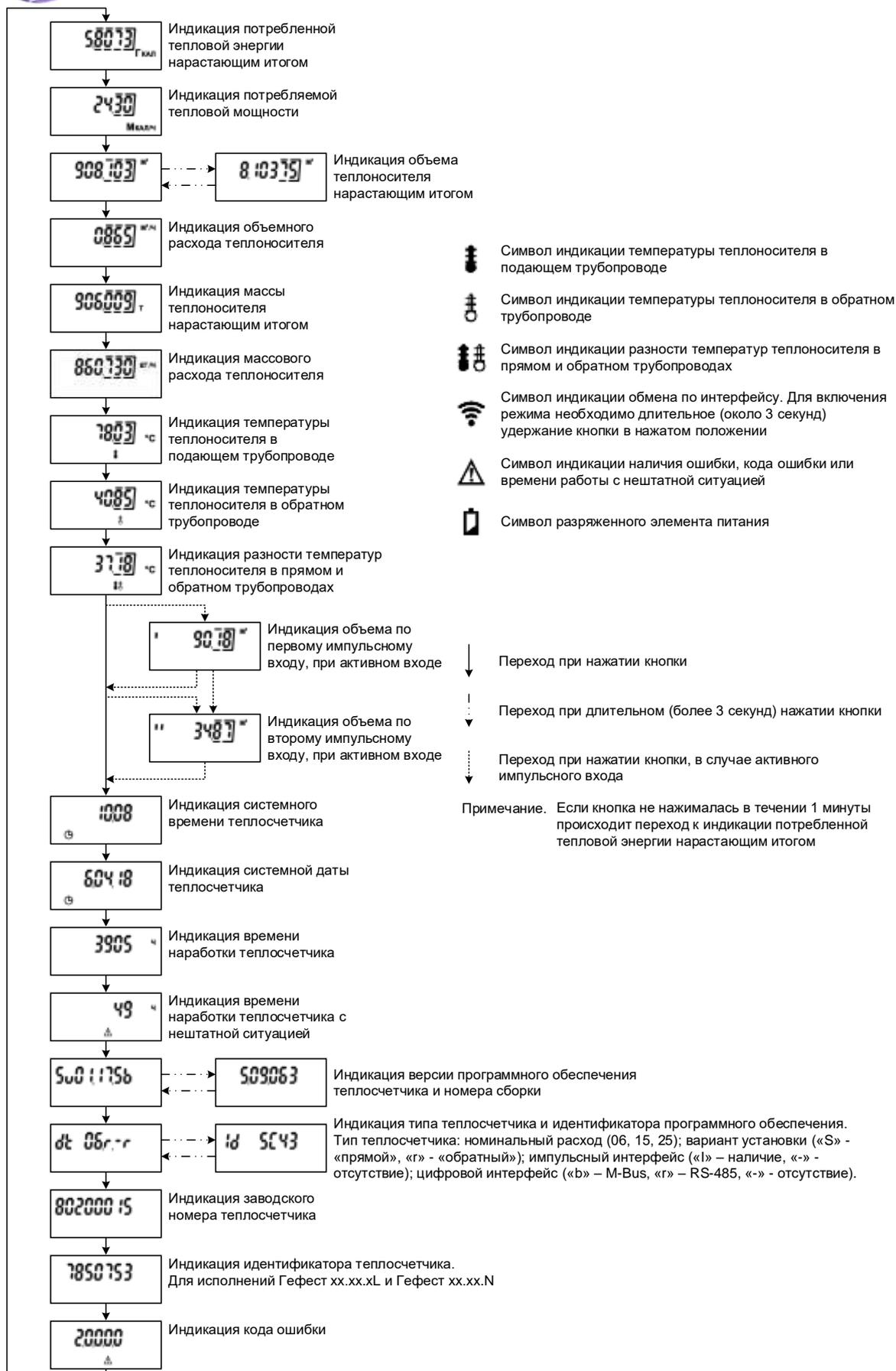
Рисунок 6. Последовательность переключения параметров на индикаторе теплосчетчика.
