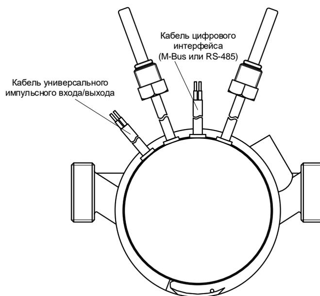
Рисунок 5. Расположение кабелей, проводных интерфейсов счетчиков тепла «Гефест», исполнений Гефест хх.IM и Гефест хх.IR.
